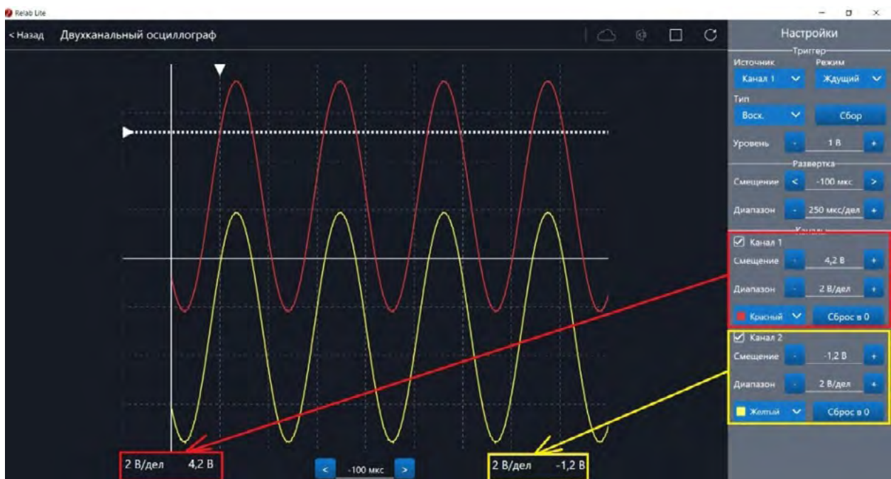
Рис. 39. Использование блока Каналы
